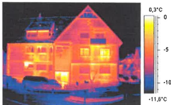
bunului inspectat. Camera de termografie masoară și interpretează lungimea de undă a radiației din spectrul infra-roșu, emisă de corpul măsurat. Hărțile de puncte obținute sunt convertite în imagini color sau alb-negru, intensitatea și paleta de culori folosită respectând diferențele de temperatură de la suprafața corpului măsurat. Termogramele care rezultă în urma inspecției sunt interpretate de către un inginer termotehnicist, pentru a putea servi scopurilor enunțate mai jos.
